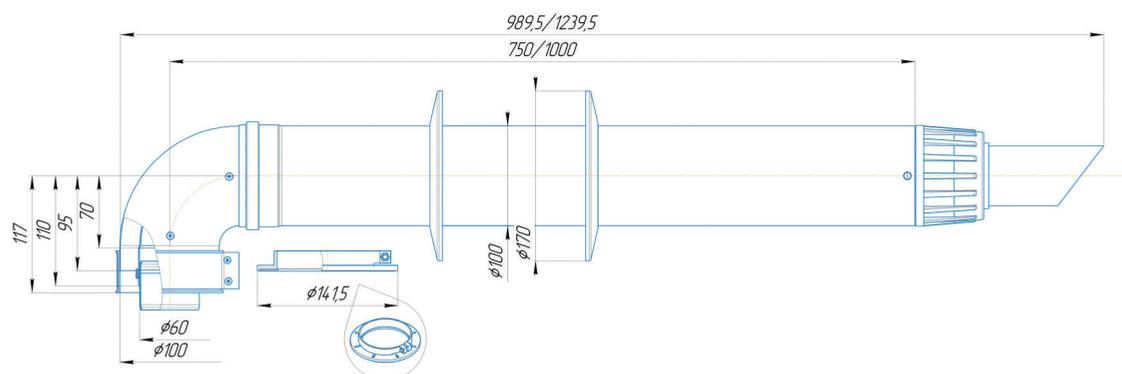
Производство дымоходов для газовых котлов — ООО «ТЕХНОМАШ»
