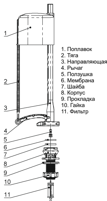
Рис. 1 - Клапан впуска (нижняя подводка)
