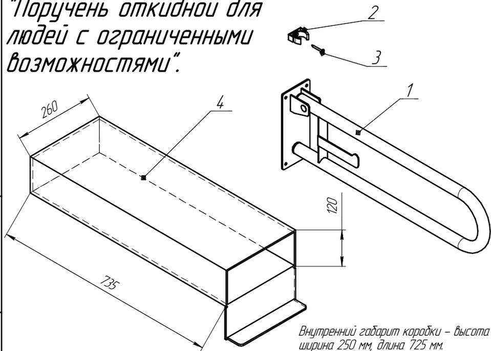
Внутренний габарит коробки - высота 110 мм,
