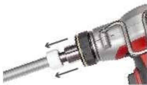
4. Включить расширитель. После каждого цикла расширения без усилий надвигать трубу на головку расширителя. Каждый цикл расширения сопровождается отчетливо слышимым щелчком расширительной головки. После полного надвижения трубы на головку необходимо провести несколько циклов расширения. В стандартных условиях:
