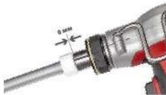
5. После фазы расширения в течение 4-5 секунд в трубу должен быть установлен фитинг до упора. В течение минуты трубы полностью сожмется, создав радиальные усилия обжима монтажного штуцера фитинга;
