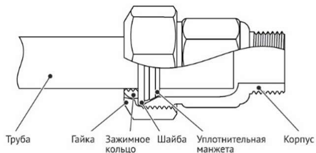
Рис. 3 Монтаж обжимной муфты.
