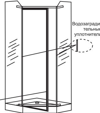
5. После установки дуг с помощью гаек (11 и 3) и шпилек (16), зафиксируйте петли (2) на верхней и нижней дугах с учетом правого или левого положения открывания двери.
