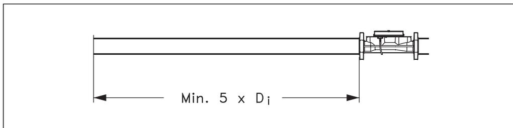
5. Присоединение расходомера к трубопроводу с диаметром, отличным от диаметра условного прохода расходомера, производится при помощи переходников, устанавливаемых вне зоны прямолинейных участков. (Допускается любой угол конуса переходников.)
