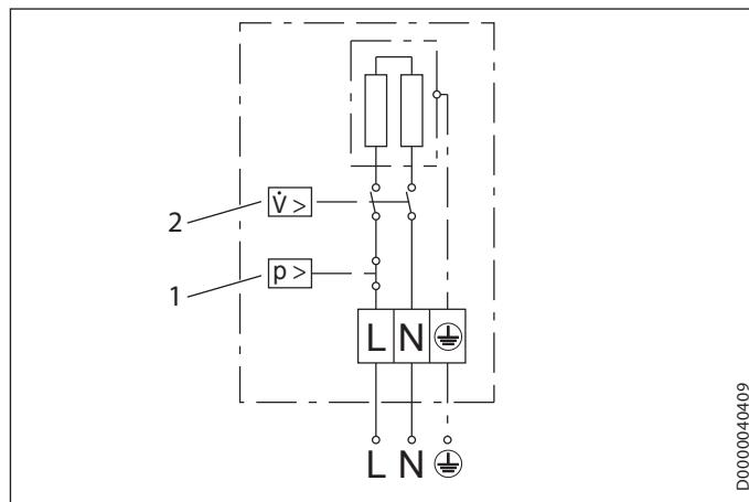
1 Предохранительный ограничитель давления
