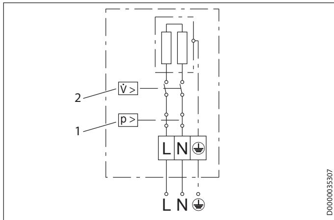
1 Предохранительный ограничитель давления
