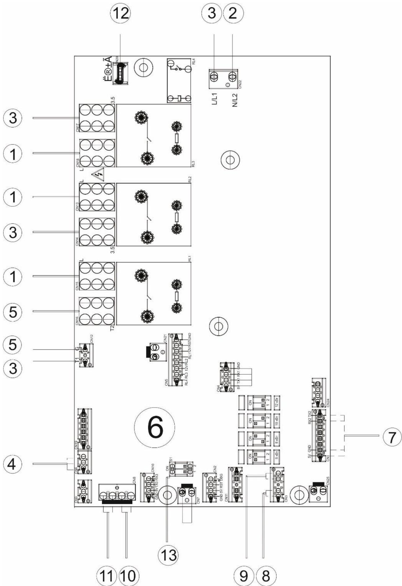
Рис. 16. Электрическая схема основной платы управления
