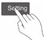
Текущая установленная температура (по умолчанию 42 С°) будет отображаться на дисплее и мигать один раз в секунду. Необходимая температура может быть установлена нажатием кнопок регулировки [V] и [^]. После завершения настройки нажмите кнопку настройки [Setting], чтобы подтвердить настройку, или настройка будет подтверждена автоматически через 5 секунд.
