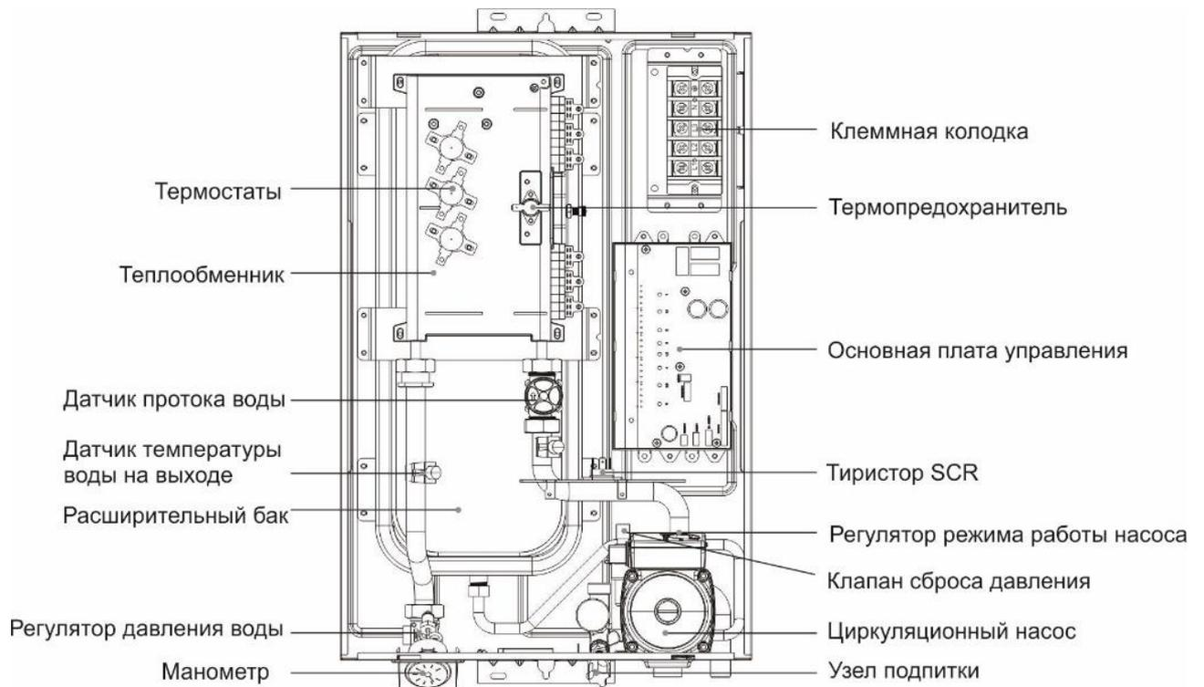
Рис. 2. Схема внутреннего устройства изделия
