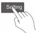
Текущая установленная температура (по умолчанию 48 С°) будет отображаться на дисплее и мигать один раз в секунду. Необходимая температура может быть установлена нажатием кнопок регулировки [V] и [^]. После завершения настройки нажмите кнопку настройки [Setting], чтобы подтвердить настройку, или настройка будет подтверждена автоматически через 5 секунд.
