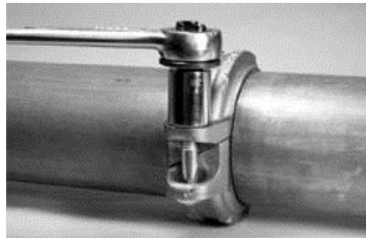
6. Вставьте оставшийся болт и наверните на него гайку, затянув ее вручную.
