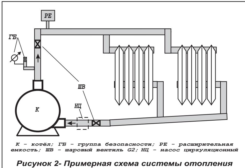
**Рисунок 2- Примерная схема системы отопления**
