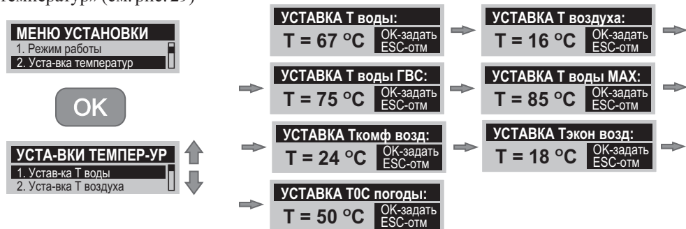
Рисунок 29. Установка температурных параметров.
