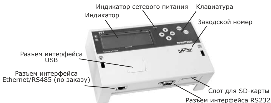
Рис. 2.1 – Внешний вид приборного отсека ТВ7 (вид сверху)
