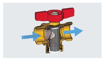
Когда кран открыт, теплоноситель проходит через фильтр, затем он замедляется, чтобы обеспечить отделение твердых частиц. Примеси фильтруются при прохождении через металлическую сетку и попадают на дно колпачка. Специальная структура корпуса крана позволяет эксплуатировать всю поверхность фильтра, увеличивая время работы краны без очистки фильтра.
