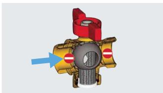
Когда клапан закрыт, теплоноситель не может проходить через фильтр, так как он изолирован от остальной части гидравлического контура. В этом положении можно ослабить нижний колпачок и вытащить фильтр, чтобы промыть его чистой водой и восстановить поверхность фильтрации.
