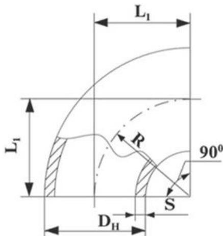
Таблица 1. Геометрические характеристики крутоизогнутых отводов.
