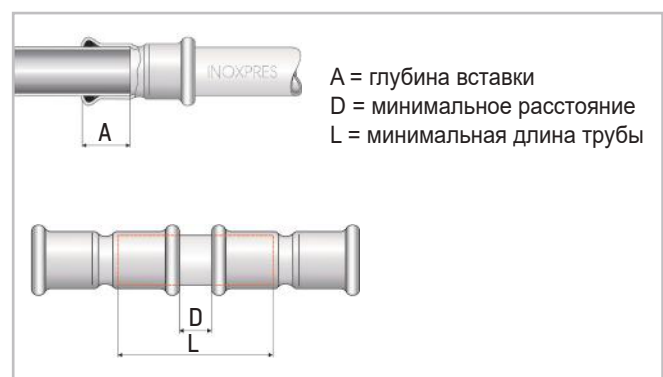
Рис. 27. Глубина вставки и минимальные размеры.
