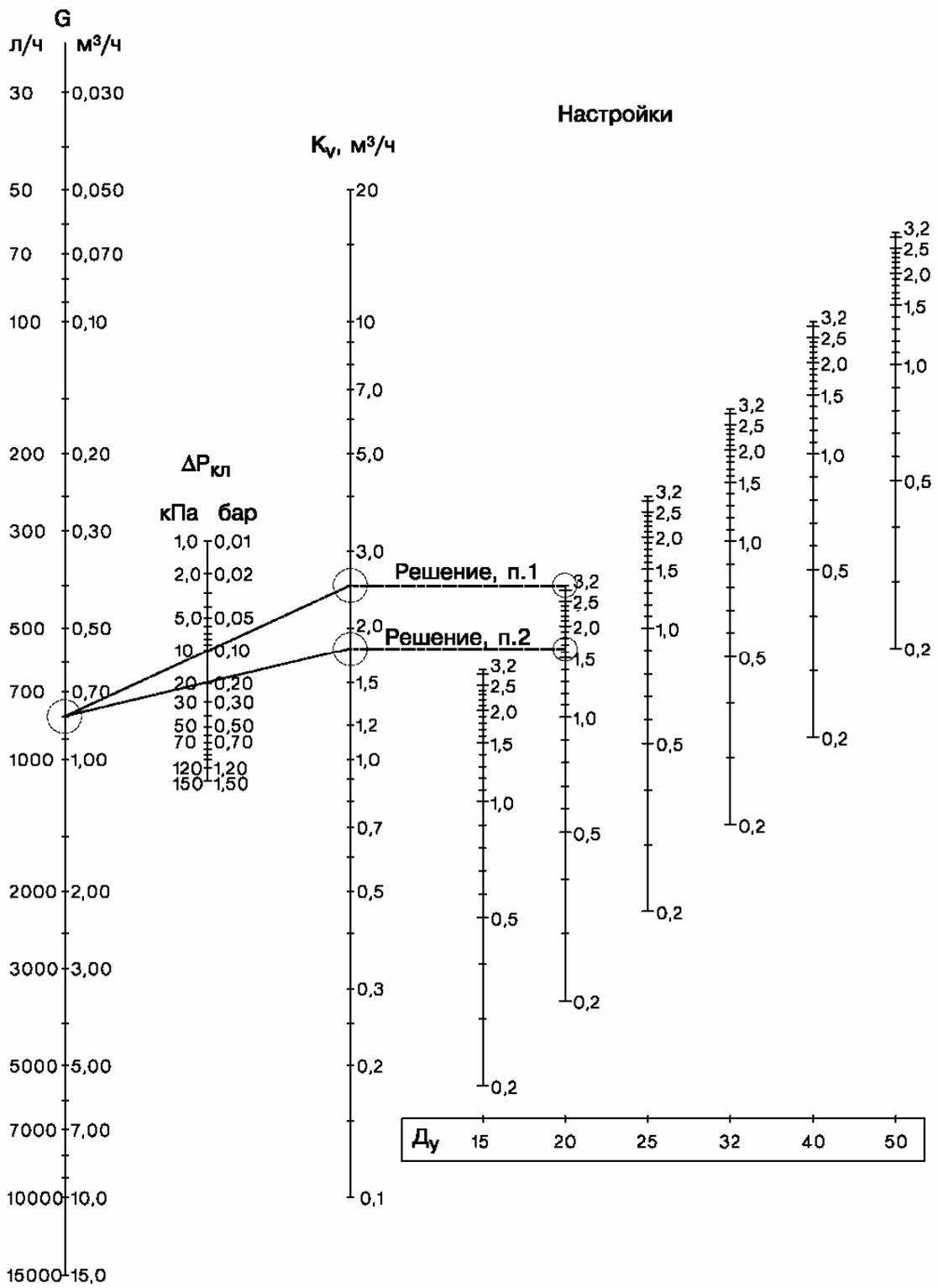
На диаграмме значения расхода  $G$  ( $м^3/ч$ ), потери давления в клапане  $\Delta P_{кл}$  ( $бар$ ) и  $K_v$  ( $м^3/ч$ ) связаны зависимостью:
