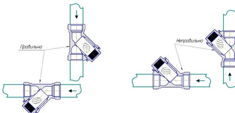
При направлении потока снизу-вверх, необходимо выполнить горизонтальный участок для правильной установки фильтра, иначе установка фильтра приведет к засорению нижнего отвода (угольника или тройника) трубопровода.
