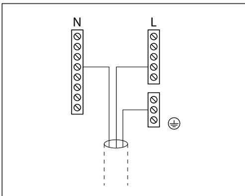
Общая клемма заземления используется для подключения соответствующих компонентов (насосы, регулирующие клапаны с электроприводом).
