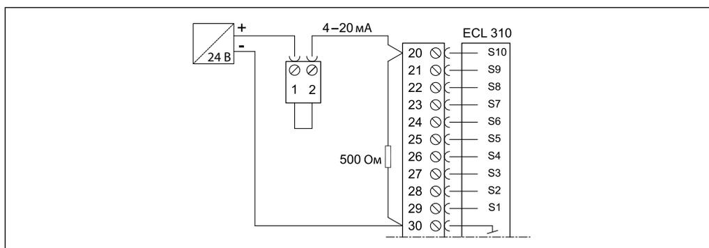
Сигнал 4–20 мА преобразуется в сигнал 2–10 В с помощью подключаемого к клеммам 20 и 30 резистора 500 Ом (не входит в комплект поставки).
