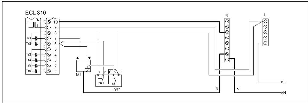
**Электрическое соединение на ~230 В с термостатом безопасности, контур 2**
