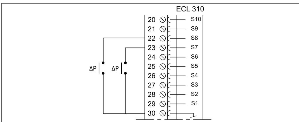
**Подключение датчика давления S10 с выходным сигналом 0–10 В**
