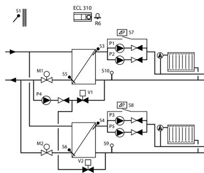
Приложение А361.2. Две системы отопления, присоединенные к тепловым сетям централизованного теплоснабжения по независимой схеме (с возможностью ограничения температуры возвращаемого теплоносителя в соответствии с температурой теплоносителя на входе в тепловой пункт). Управление спаренными циркуляционными насосами и системой подпитки
