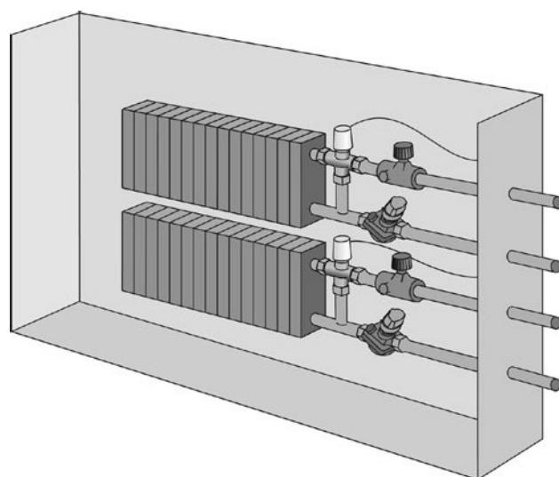
**Рис. 25.** Пример применения клапанов AB-QM на обвязке фэнкойлов в системах с постоянными гидравлическими характеристиками
