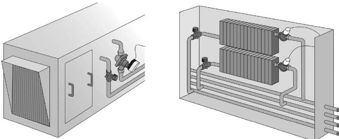
**Рис. 23.** Пример применения клапанов AB-QM на обвязке центральных кондиционеров и фэнкойлов в системах с переменными гидравлическими характеристиками
