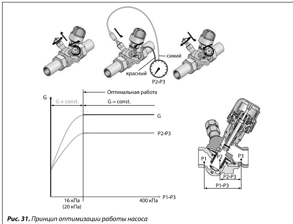
*Рис. 31. Принцип оптимизации работы насоса*
