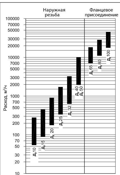
**Рис. 30.** Диаграмма для выбора диаметра клапанов серии AB-QM
