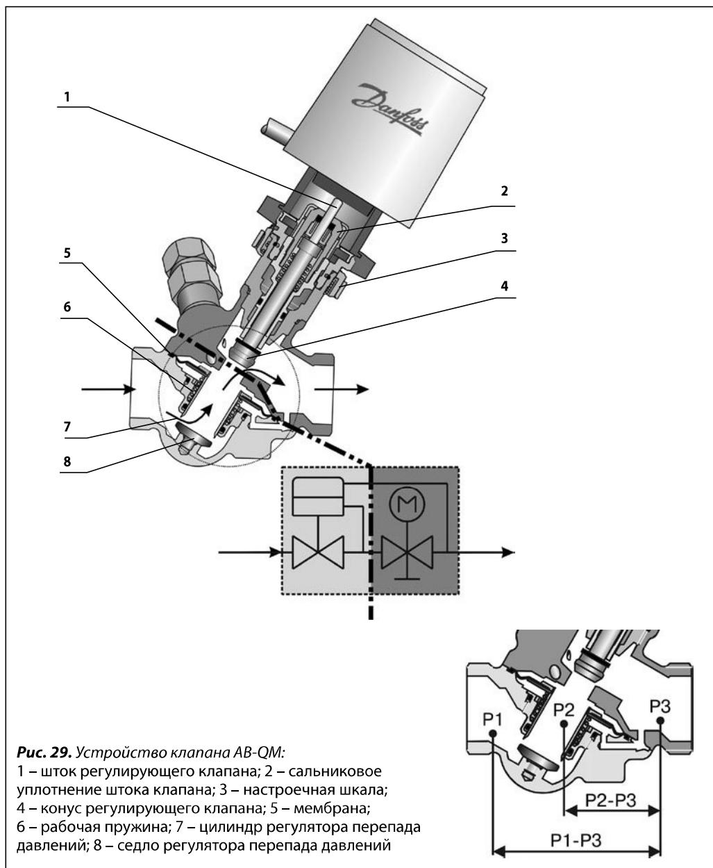
**Рис. 29. Устройство клапана AB-QM:**
