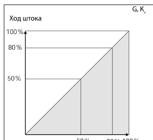
Рис. 27. Характеристика регулирования клапана AB-QM
