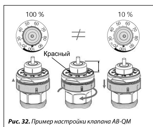
*Рис. 32. Пример настройки клапана AB-QM*
