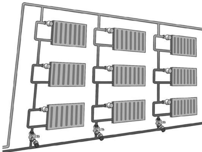
**Рис. 26.** Пример применения клапанов AB-QM на стояках однотрубной системы отопления
