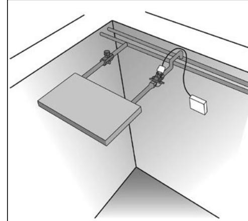
**Рис. 24.** Пример применения клапанов AB-QM на обвязке охлаждающих потолочных панелей в системах с переменными гидравлическими характеристиками
