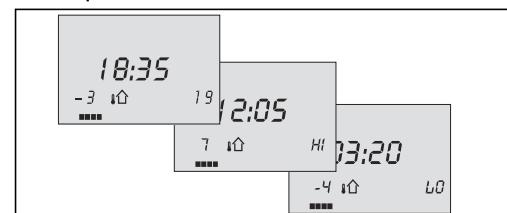
На дисплее могут быть показаны время и текущая температура наружного воздуха. Возможно отображение наименьшей и наибольшей температуры наружного воздуха после полуночи.
