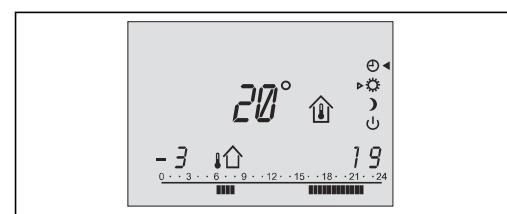
Возможна установка периодов времени с комфорной и пониженной температурой воздуха в помещении, а также требуемое значение температуры воздуха в помещении.
