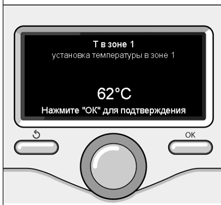
Изменение температуры горячей воды отопления
