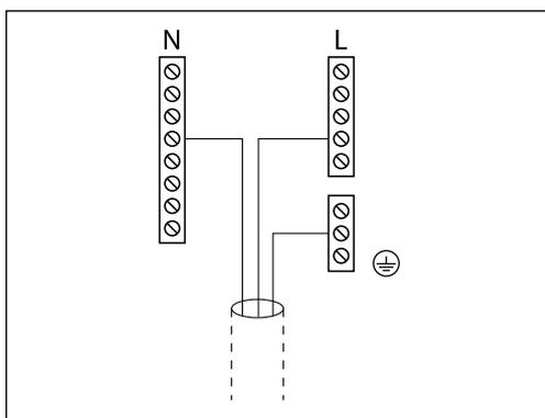
Общая клемма заземления ⊕ используется для подключения соответствующих компонент (насосы, регулирующие клапаны с электроприводом).
