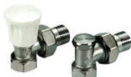
Ручные комплекты Giacomini R705K и R706K являются наиболее экономным решением. Они состоят всего из двух элементов – ручного радиаторного клапана и отсечного клапана. Регулирование температуры в этом случае осуществляется в ручном режиме – потребитель просто поворачивает ручку клапана, чтобы увеличить или уменьшить подачу теплоносителя и тепловую мощность отопительного прибора.
