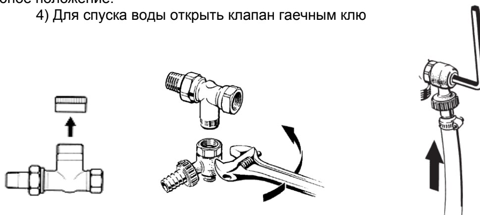
Рис. 3. Монтаж спускного крана.
