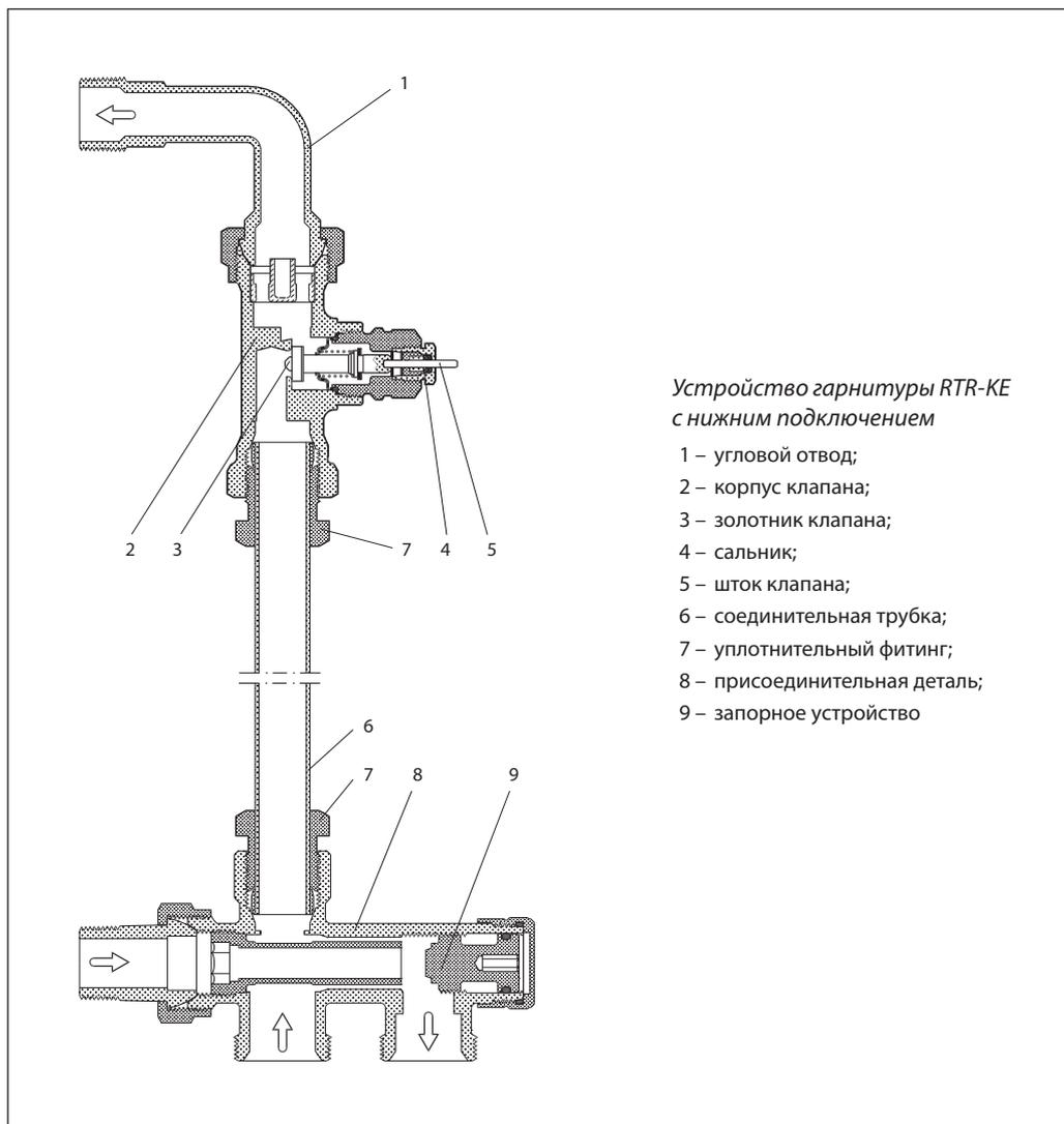
Устройство гарнитуры RTR-KE с нижним подключением
