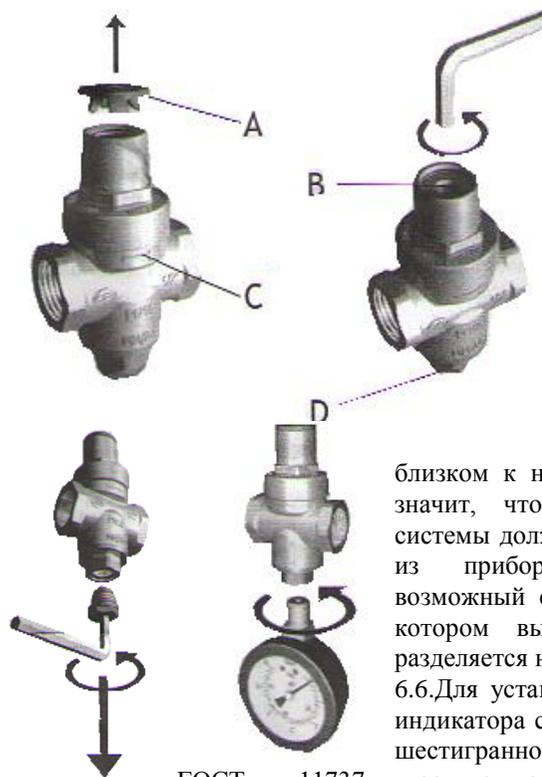
6.4. Для настройки редуктора следует снять защитную пластиковую заглушку **C**. Настройка производится вращением настроечной гайки **B** шестигранным ключом **S5**. Вращение по направлению стрелки увеличивает значение настроечного давления. Обратное вращение уменьшает давление.
