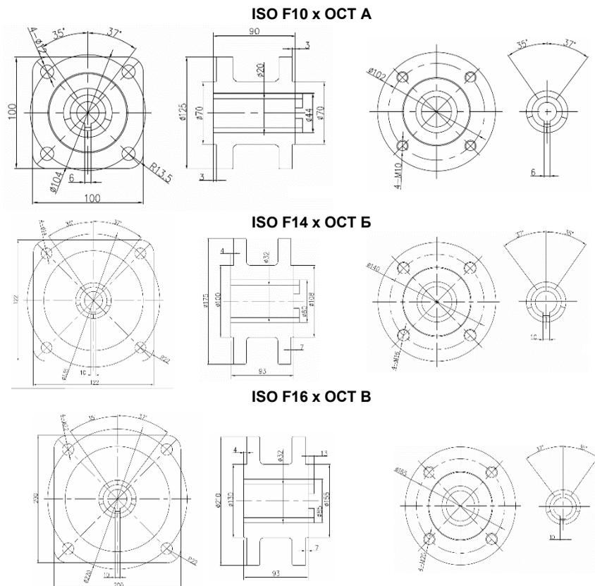
Рис. 1. Геометрические характеристики переходных фланцев.
