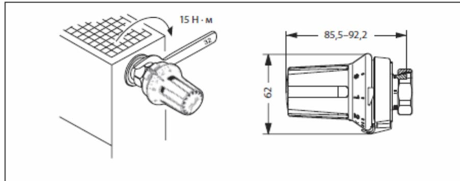
Монтаж термостатического элемента серии RTRW-K на клапан терморегулятора производится легко и быстро с помощью соединительной гайки M 30 x 1,5.
