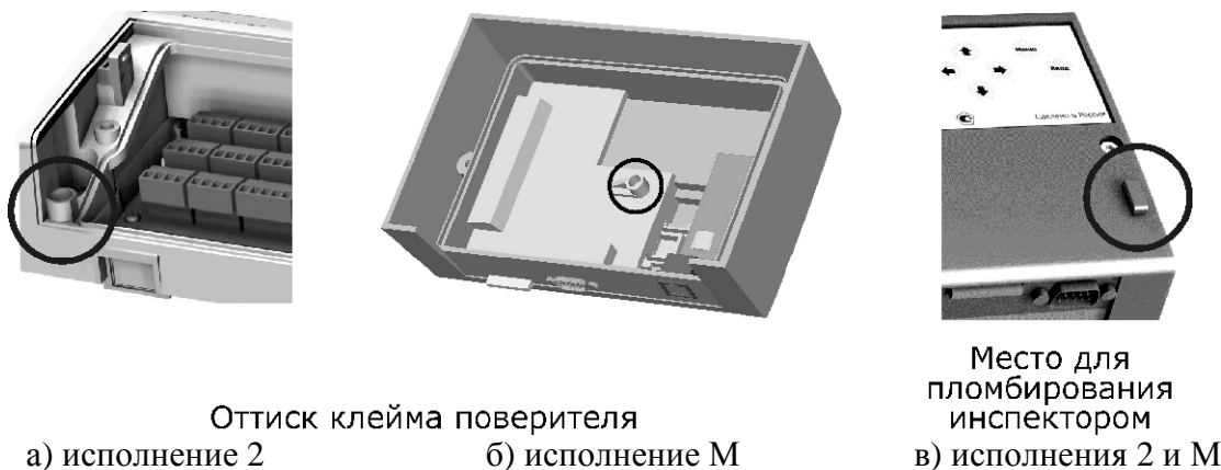
Рисунок 2 - Схема пломбировки тепловычислителя
