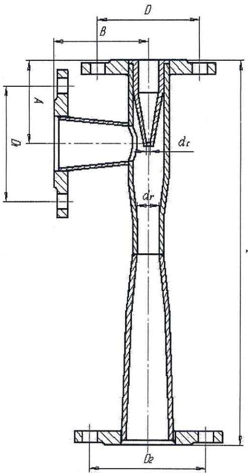
Материал корпуса, лиффузора, фланцев и сопла – сталь.
