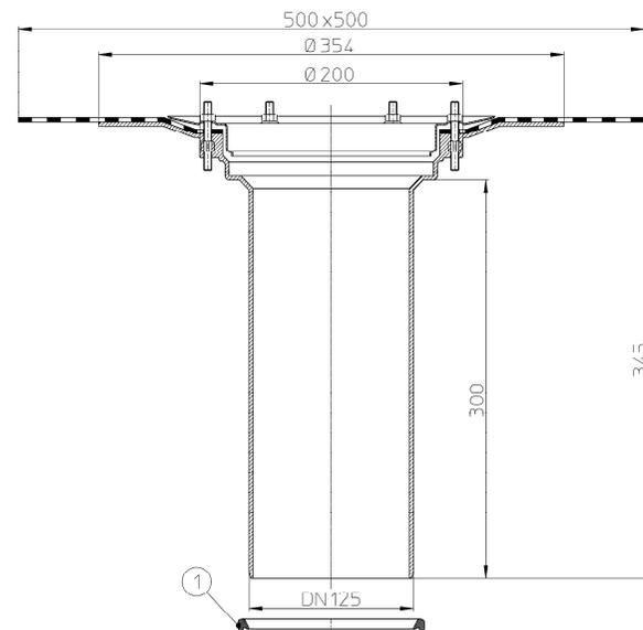
2. Слой пароизоляции обжимается или приваривается (в зависимости от типа воронки) к корпусу HL62 (64).
