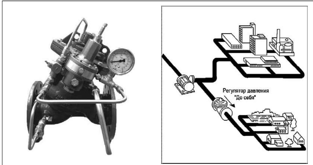
Регулятор давления тип **С301-R** предназначен для регулирования и поддержания давления "до себя" на постоянной установленной величине независимо от колебаний давления и расхода.
