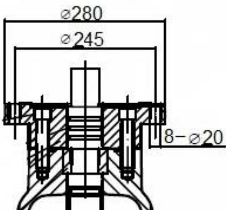
б) Устройство присоединительного фланца задвижки Ду700, Ду800 под редуктор.
