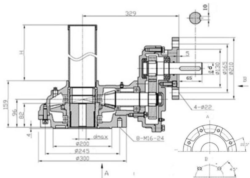
а) Устройство редуктора задвижки Ду700, Ду800
