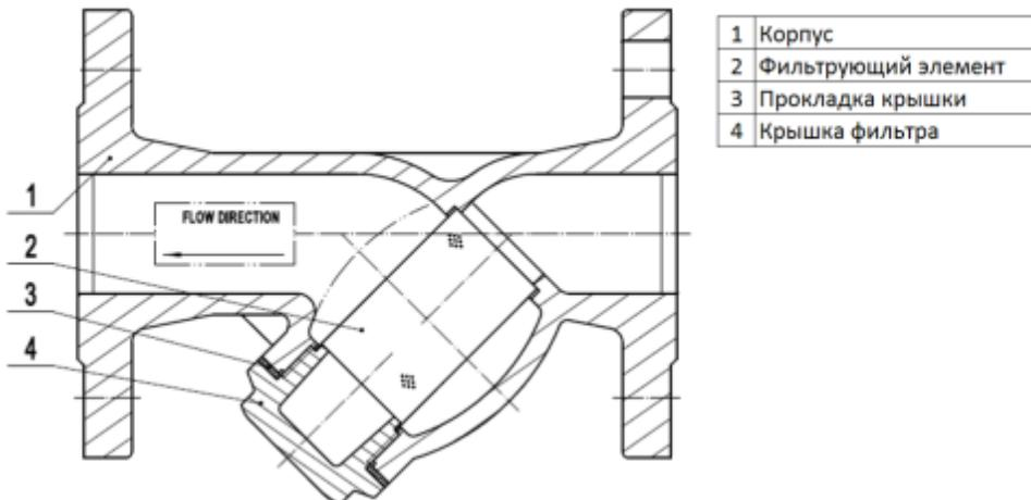
Вода проходит через ячейки фильтра сетчатого и очищается от механических взвесей. Конструкция фильтра и порядок его установки предполагает заполнение отстойника фильтра сетчатого механическими взвесями.
