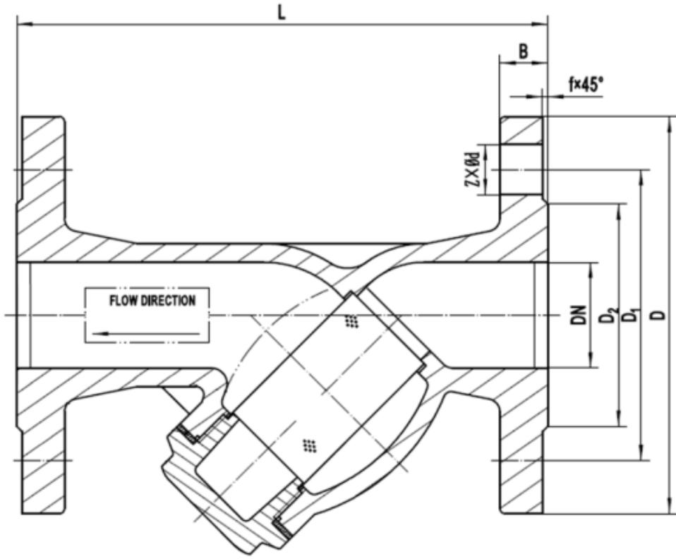
Габаритные размеры фильтров сетчатых типа ФСФ
