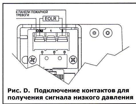
**Рис. D. Подключение контактов для получения сигнала низкого давления**
