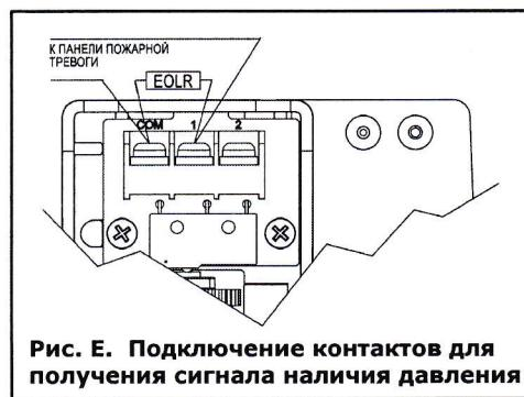
**Рис. Е. Подключение контактов для получения сигнала наличия давления**
