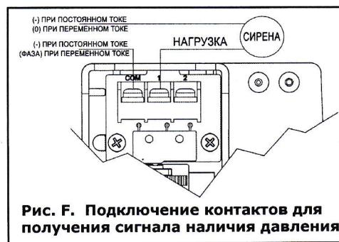
**Рис. F. Подключение контактов для получения сигнала наличия давления**
