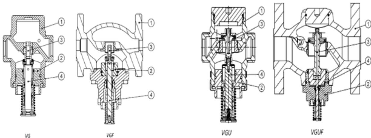
1. Корпус клапана
