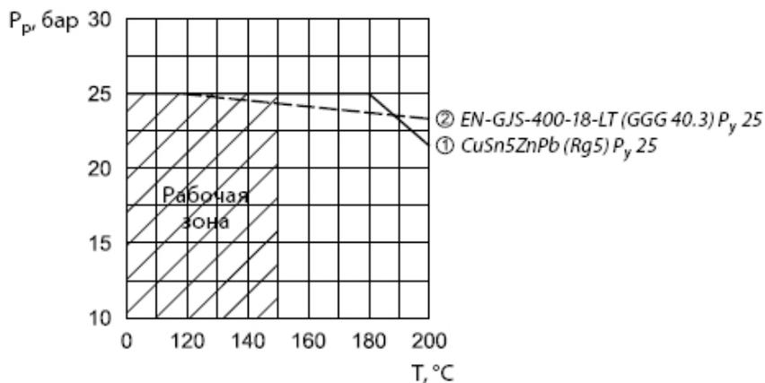
Зависимость рабочего давления от температуры регулируемой среды (в соответствии с EN 1092-3).
