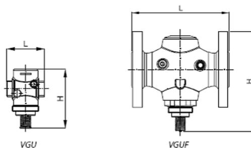
Рис. 3. Габаритные и присоединительные размеры клапанов VGU, VGUF
