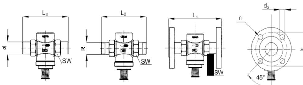
Рис. 2. Габаритные и присоединительные размеры клапанов VG, VGF
