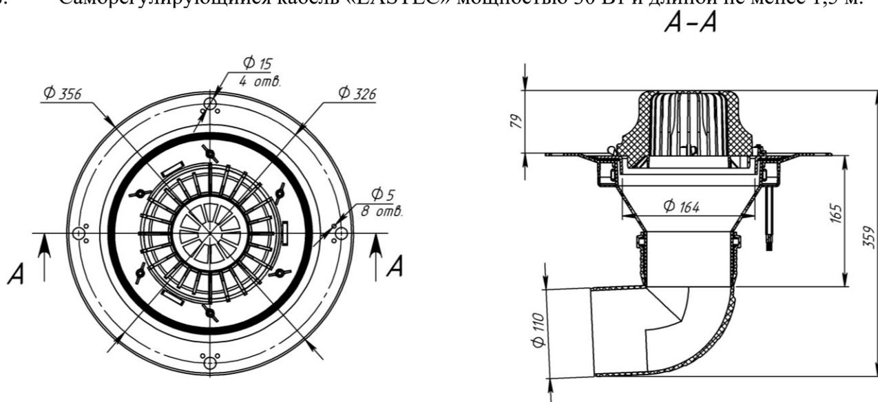
Рис. 1. Схема воронки VMCO
