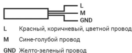
Рис. 2. Схема подключения
