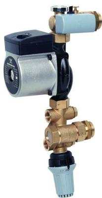
Компактные смесительные узлы Данфосс используют для регулирования расхода и температуры теплоносителя, подаваемого в систему гидравлического напольного отопления. Конструкция смесительного узла позволяет монтировать его как с левой, так и с правой стороны распределительного коллектора. Подключение подающего и обратного трубопроводов производится сбоку в нижней части смесительного узла.
