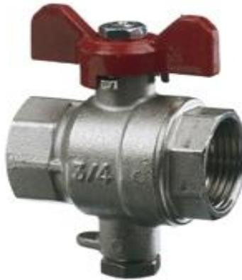
Шаровой кран предназначен для подключения второго датчика температуры 5.2 мм (M10x1) теплосчетчика Sonometer 1100, Sonometer 500 или M-Cal MC, а также может быть использован в качестве запорной арматуры. Материал корпуса крана: никелированная латунь.
