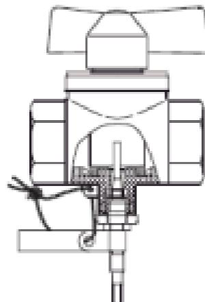
Шаровой кран с датчиком температуры
