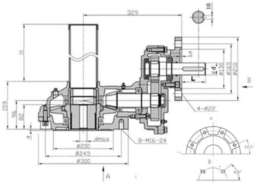
а) Устройство редуктора задвижки Ду700, Ду800
