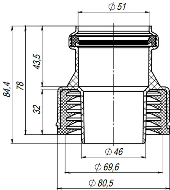
Рис 1. Муфта с ПВХ/ПП на чугун/сталь 50x50
