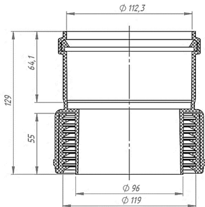
Рис 2. Муфта с ПВХ/ПП на чугун/сталь 110x100
