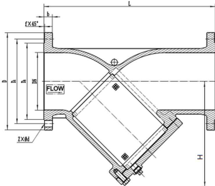
Габаритные размеры фильтров сетчатых типа ФСФ
