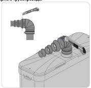
7.8. Установка канализационная предназначена для подключения унитазов с горизонтальным выпуском, центр выпуска должен быть расположен на расстоянии 180 мм от пола. Минимальное расстояние от выпуска унитаза до задней стены должно быть 245 мм.
