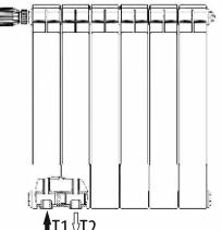
Диаметр резьбы присоединительных отверстий G1/2"
