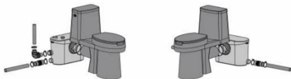
7.10. Горизонтальные участки труб должны иметь уклон не менее 3%. При подключении душевой кабины, расстояние от сливного отверстия поддона кабины до поверхности, на которой установлена установка канализационная, должно быть не менее 14 см с уклоном отводящей трубы не менее 2%. Необходимо устанавливать фильтры-сетки на входные отверстия сифонов душевого поддона, умывальника, мойки.
