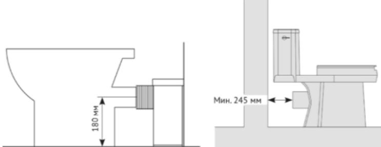
7.9. Канализационные трубы от сантехнических приборов подключаются к установке канализационной к боковым входам с помощью входных патрубков и хомутов из комплекта поставки
