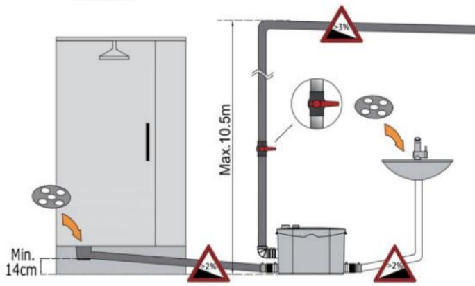
7.11. В дополнение к основным входам, на крышке расположен дополнительный вход, закрытый заглушкой. При необходимости дополнительного подключения снять заглушку подходящим инструментом, с помощью патрубка и хомута подсоединить отводящую трубу.
