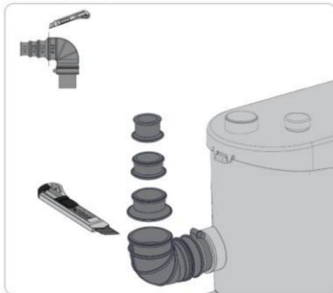
7.8. Установка канализационная предназначена для подключения унитазов с горизонтальным выпуском, центр выпуска должен быть расположен на расстоянии 180 мм от пола. Минимальное расстояние от выпуска унитаза до задней стены должно быть 245 мм.
