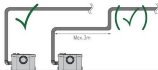
7.15. Изгибы и повороты трубопровода должны быть плавными.
