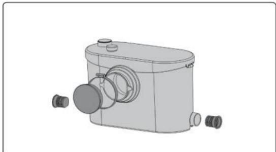
7.7. Угловой ступенчатый напорный патрубок монтируется в установку канализационную на глубину ~2 см и фиксируется червячным хомутом. При необходимости конструкция патрубка позволяет корректировать (путем отсечения) его размер, так чтобы «ступень» соответствовала диаметру напорного трубопровода.
