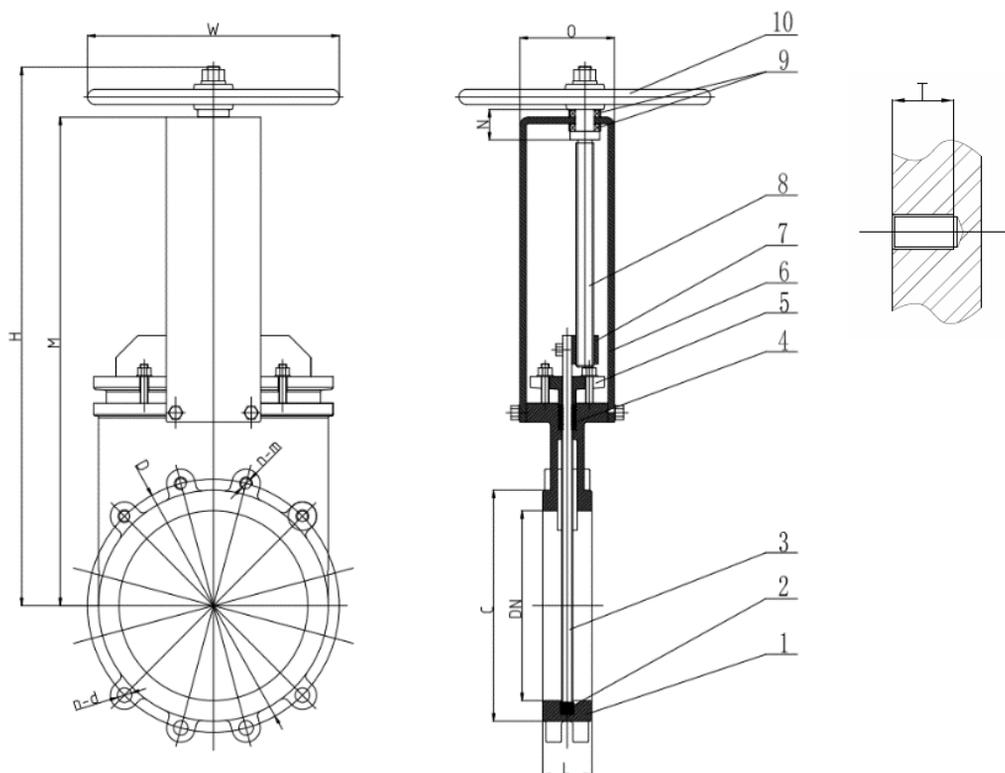
Рис. 1. Габаритные и присоединительные размеры шиберной задвижки.
