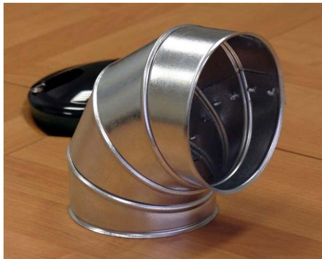
С остальными участками металлических оболочек отводы соединяются путем совмещения внутренней зиговки на одном элементе и внешней на другом.
