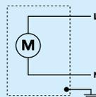
Циркуляционный насос подключается через стационарный многополюсный прерыватель.
