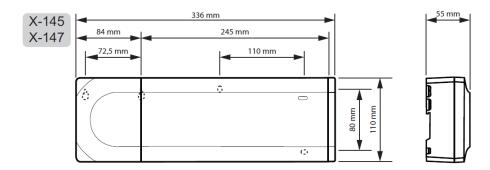
Контроллер (с дополнительным модулем, трансформатором и торцевой крышкой)
